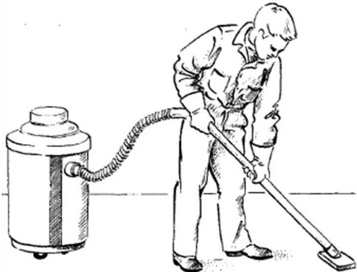
بعد: کاهش انتشار گرد و غبار در حین نظافت محیط توسط جاروی برقی مجهز به فیلتر گرد و غبار
