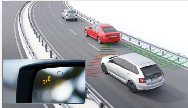
شکل ۱۰: نحوه عملکرد سیستم پایش نقاط کور خودرو
